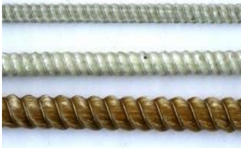
Рис. 2 – Общий вид изготовленной композитной арматуры
