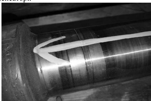
Рисунок 2 — Характерні пошкодження демонтованих шпинделів
