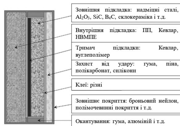
Рисунок 3 – Схематичне зображення поперечного перерізу броньової плити
