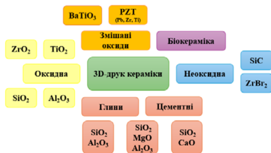
Рис. 3 – Схема класифікації керамічних матеріалів, які використовуються в аддитивному виробництві
