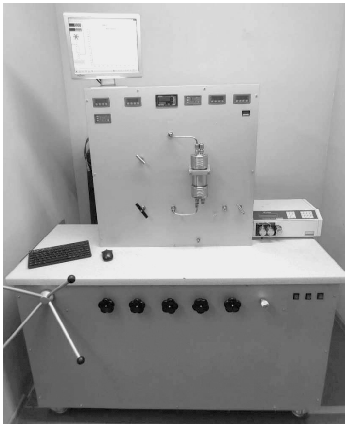
Рис. 2 Фільтраційна установка високого тиску
