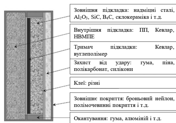
Рисунок 3 – Схематичне зображення поперечного перерізу броньової плити
